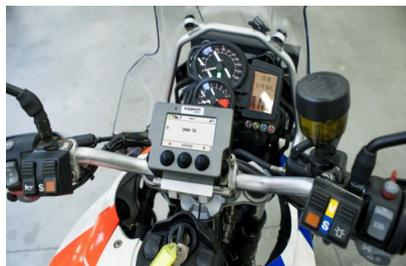
ADVANCED MRC-3 Bedieneinheit - Bluetooth-Verbindung
